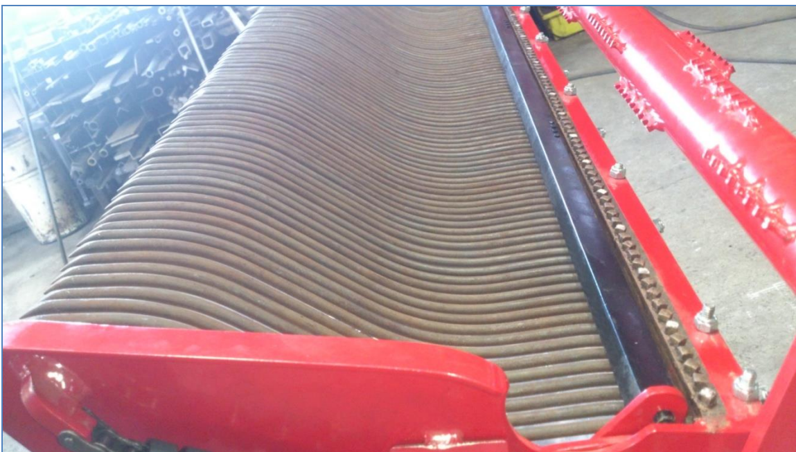
Figure 9. Série de photos illustrant l'installation des dents
