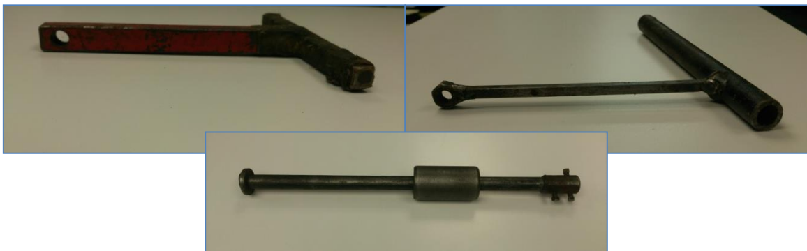
Figure 6. Exemples d'outils utilisés pour la maintenance des dents (arracher et/ou modifier légèrement la courbe)
