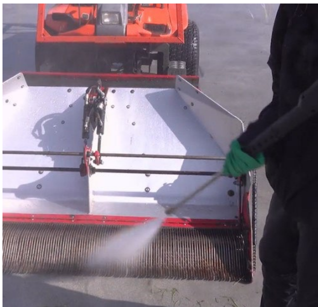
Nettoyage d'une récolteuse à bleuets pour prévenir la dissémination de la mouche du bleuet
